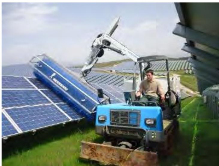
Fotografia 2. 7 – Exemplo do equipamento para limpeza dos painéis fotovoltaicos
