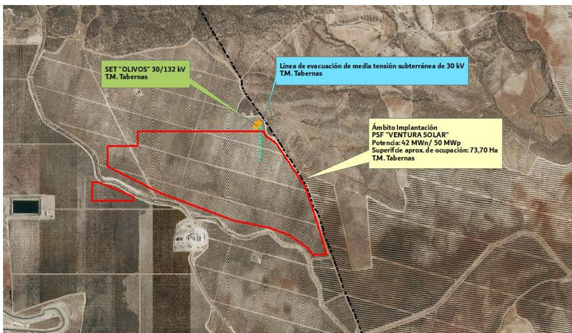
Imagen 1. Plano con las distintas infraestructuras de las que se componen el proyecto de la PSF "VENTURA SOLAR".
